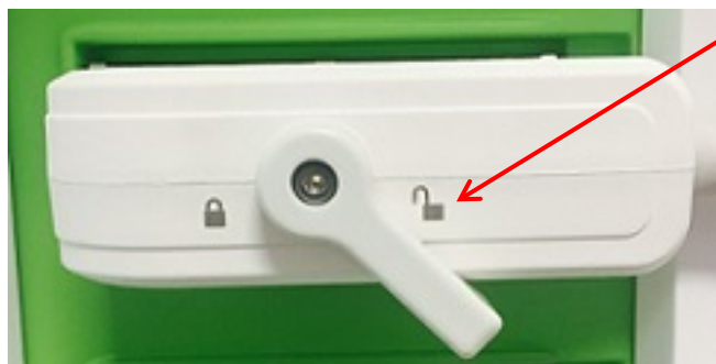
Slika 11: Odklenjen zaklepni gumb konektorja sonde
