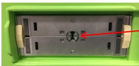
Slika 9: Zaklepna zareza na priključku za konektor sonde
